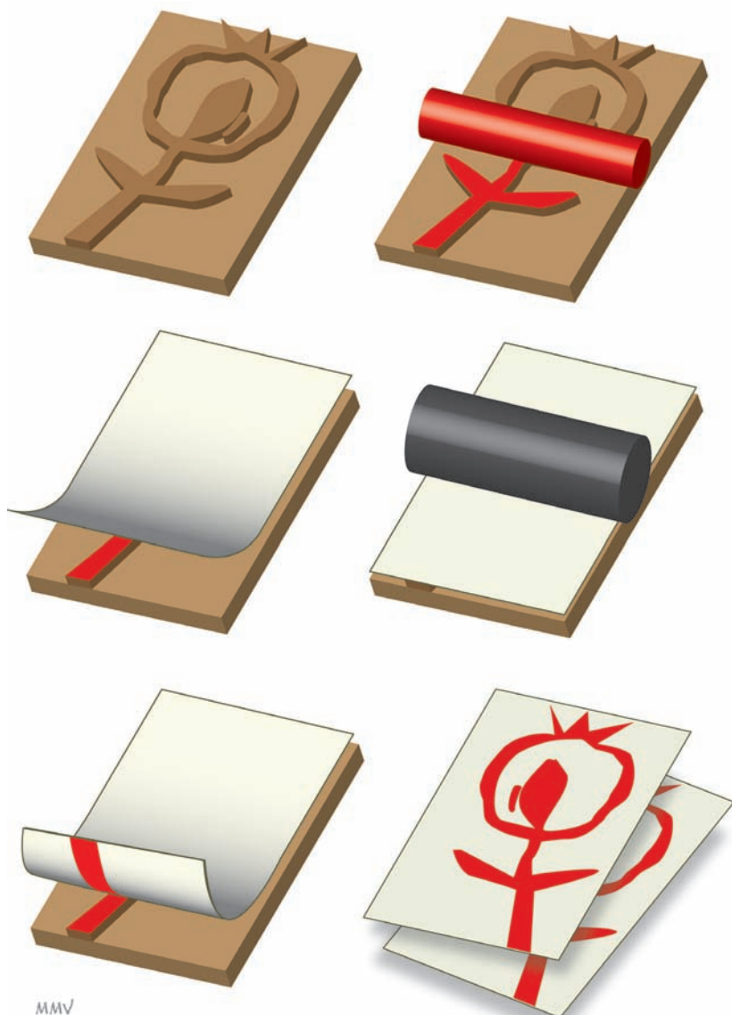
Fig. 14. Representación esquemática de la estampación de un grabado en relieve. En este tipo de grabado se deja en relieve la forma que se quiere imprimir. A continuación se entinta, se coloca el papel y finalmente se aplica presión para que la tinta se transfiera al papel. (Ilustración MMV)
