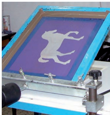
Fig. 70. Pantalla serigráfica lista para imprimir. En la zona clara (silueta de un caballo) la malla está abierta, mientras que en la zona violeta está obturada para impedir el paso de la tinta.
