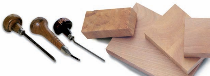
Fig. 23. Buriles para grabar y tacos de madera cortados a contrafibra.
