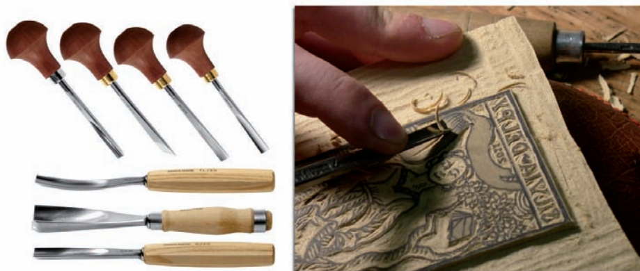
Fig. 13. Gubias para tallar la madera. A la derecha tallado de un taco de madera.
