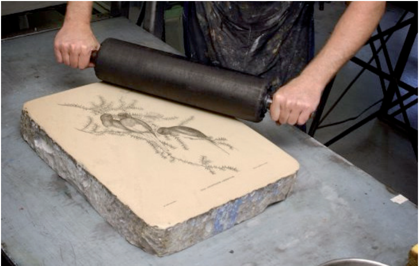
Fig. 58. Piedra litográfica. Aplicación de tinta con rodillo.
